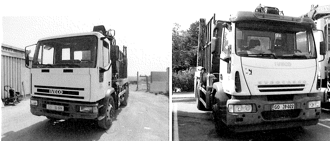
Slika: Samonakladalec z žerjavom in kotalni prekucnik
