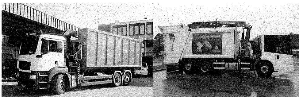
Slika: Prikoličar z dvo-prekatnim kotalnim zabojnikom ter namensko vozilo za stiskanje ločeno zbranega papirja in kartona ter mešane embalaže iz plastike in kovin
